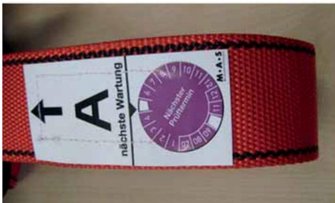
**Bild 37:** Beispiele für die Dokumentation der Sachkundigenprüfung auf der Schutzausrüstung
