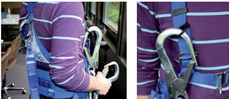
Bild 34: Einhängen des unbenutzten Seilstrangs in eine Fixieröse
