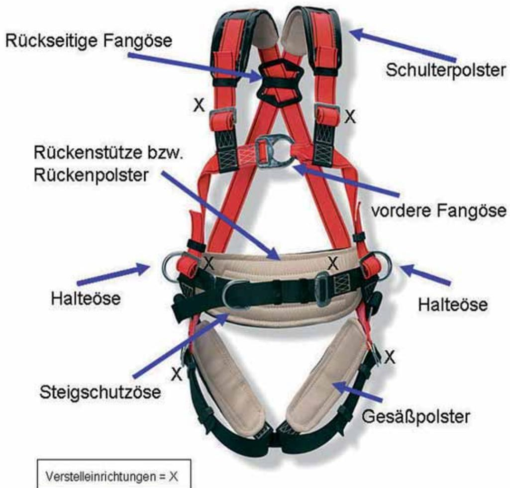
**Bild 10:** Beispiel eines Auffanggurtes mit vorderer und rückseitiger Auffangöse, seitlichen Halteösen und einer Steigschutzöse. Der Gurt ist zusätzlich mit Schulter-, Bein- und Rückenpolstern ausgestattet
