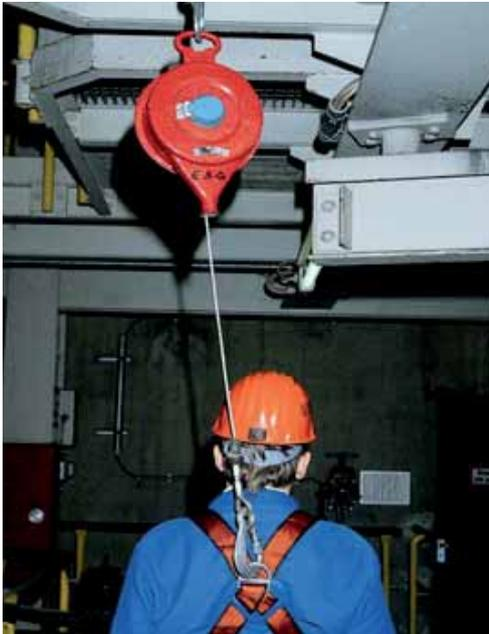
Der Auffanggurt ist mit einem Verbindungselement des ein- und ausziehbaren Verbindungsmittels des Höhensicherungsgerätes verbunden. Im Sturzfall arretiert das Höhensicherungsgerät mittels integrierter Bremsvorrichtung und hält die zu sichernde Person.
