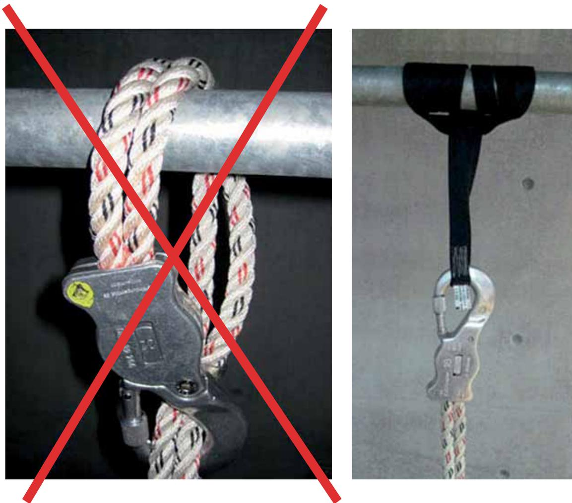
**Bild 36:** Richtiges Anschlagen: Zur Erhaltung der Funktionsfähigkeit des Reibungsfalldämpfers wird eine Bandschlinge als Anschlaghilfe verwendet
